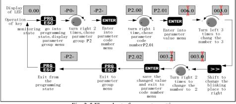
Fig. 3-5 Flow chart of parameter setting
