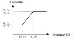
Fig. 5-8-1 PI parameters schematic diagram
