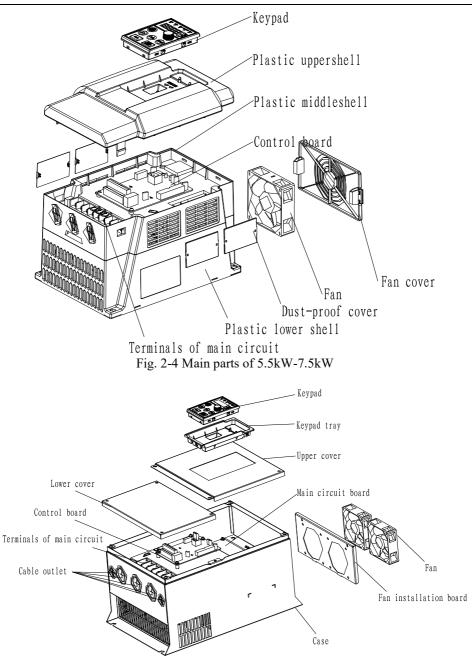
Fig. 2-5 Main parts of 11kW-160kW
