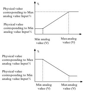
Fig. 5-4-1 Analog input linear curve
