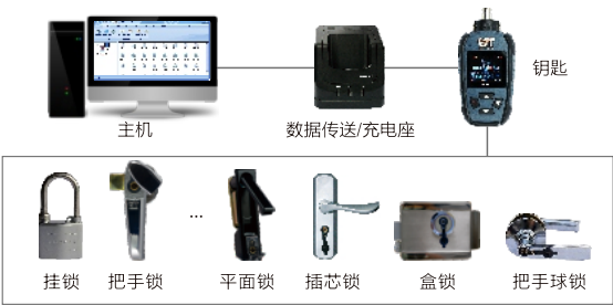
图1 JOYO-E1智能锁具管理系统结构图
