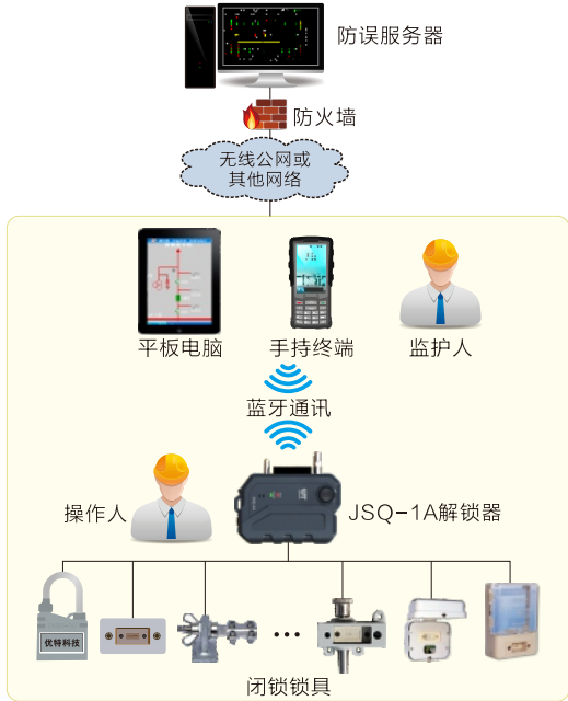
电子操作票系统应用示意图。
