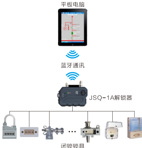
低中端变电站防误闭锁系统应用示意图
