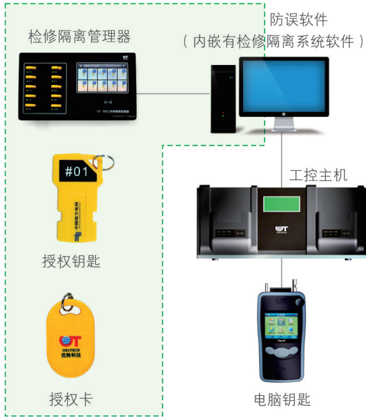
检修隔离管理装置结构图
