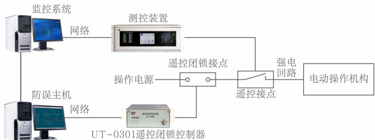
图2 遥控闭锁功能示意图
