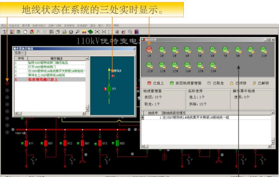
挂接1#接地线后，地线实时状态通过UT-Net无线网络上传给五防主机。红色代表地线处于已挂接状态。
