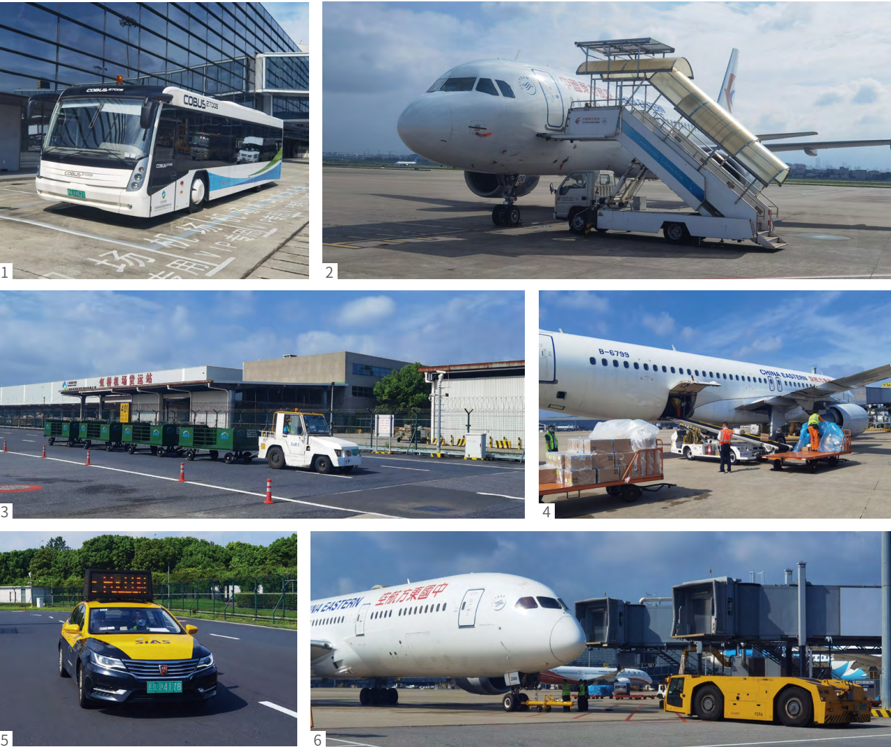
① 摆渡车 ② 客梯车 ③ 行李牵引车 ④ 行李传送车 ⑤ 飞机引导车 ⑥ 飞机牵引车
