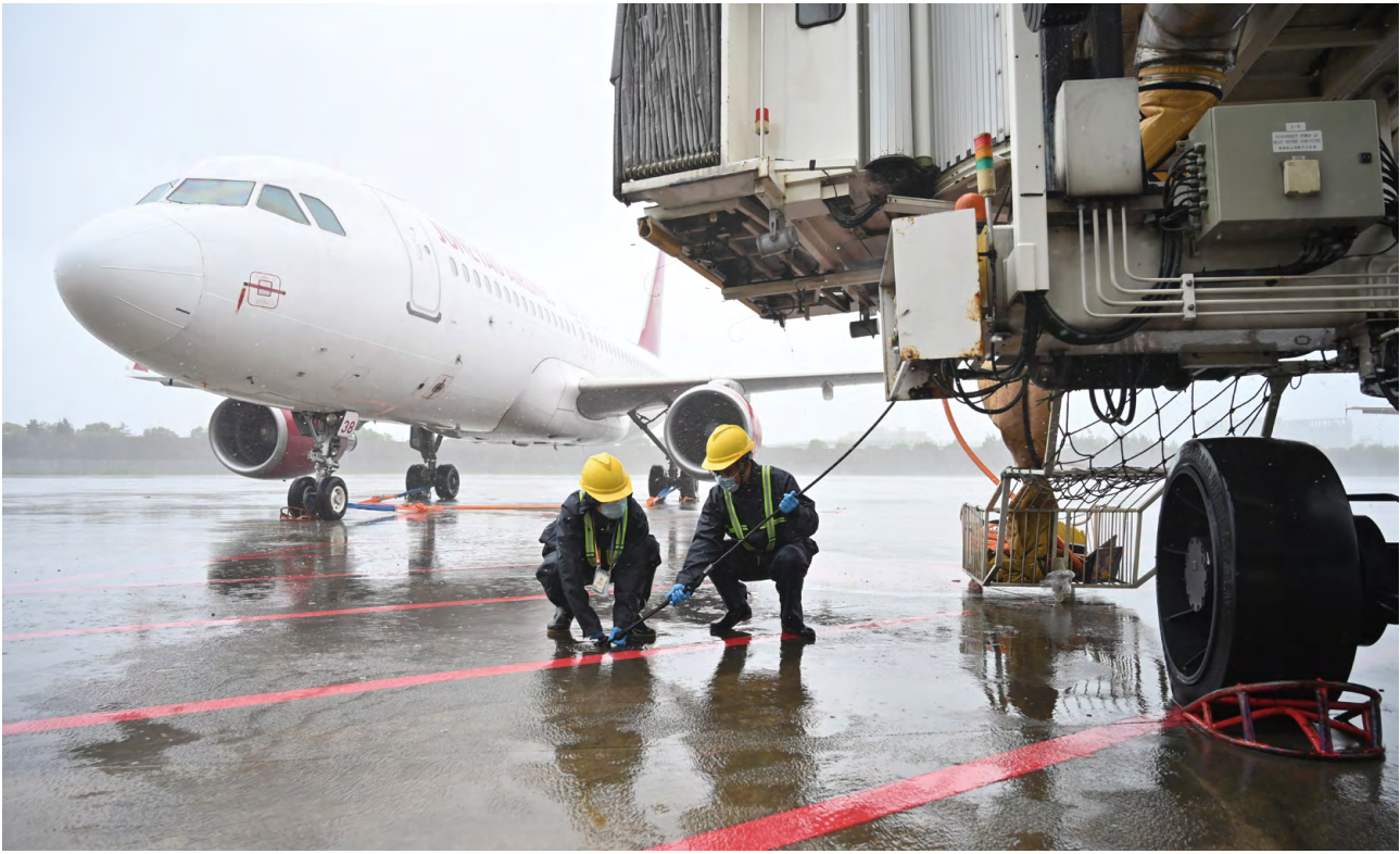
对飞机系留、登机桥加固情况进行巡检
