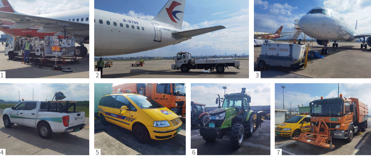
① 飞机加油车 ② 飞机清水车 ③ 飞机电源车 ④ 超声波驱鸟车 ⑤ 跑道摩擦系数测试车 ⑥ 机坪土面区割草车 ⑦ 跑道清扫车
