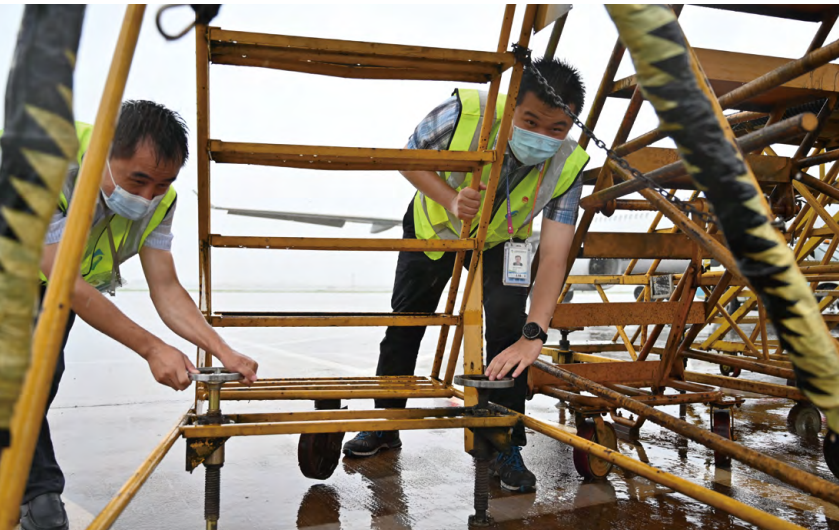
加固系留机坪无动力设施设备（上图） 系留加固手推车（下图）
